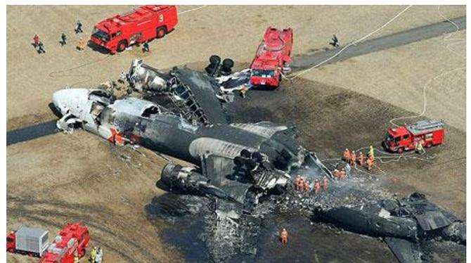
Fig.9. Catastrophe du MD-11 à Tokio le 23 mars 2009. La catastrophe type 1B – l'avion est tombé au sol en se fragmentant perpendiculairement à son axe et plus tard l'explosion a détruit sa partie arrière en la déchirant et l'ouvrant longitudinalement.
