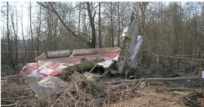
Fig. 23. Reste du stabilisateur vertical avec les fragments de stabilisateurs horizontaux adjacents à lui [6]. Les parties des stabilisateurs qui manquent se sont détachés auparavant.
