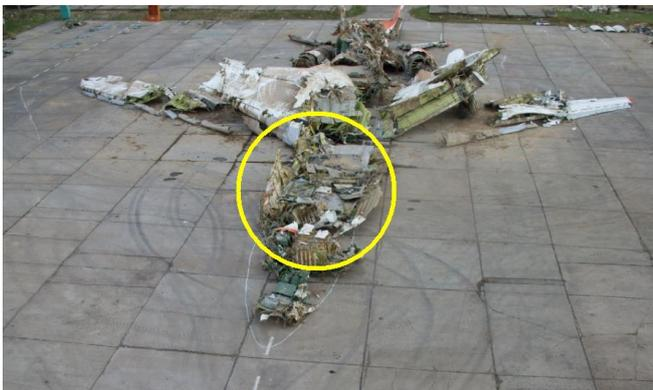
Fig. 4. Epave de l'avion type Tu-154 sur l'aérodrome à Smolensk [6]. Même dépourvu du plafond et d'une grande partie des bords à la suite du découpage on voit bien que le fuselage a été déchiré et non pas écrasé.
