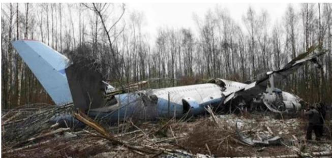
Fig. 6. Catastrophe du Tu-204 à Moscou le 22 mars 2010. La catastrophe type 1A – l'avion est tombé au sol sans exploser.
