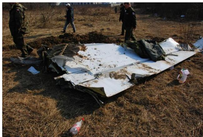
**Fig. 21. Partie arrière du stabilisateur horizontal gauche avec le gouverne de profondeur gauche placés dans la zone B5 [17].**
