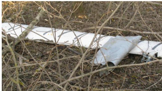
**Fig. 20. Intercepteur (déflecteur) de l'aile gauche posé au sol dans la forêt à environ 10 m de la rue Kutuzow. Sur le dessus de celui-là se trouve un morceau de l'aileron. Photo prise par Jan Gruszyński.**
