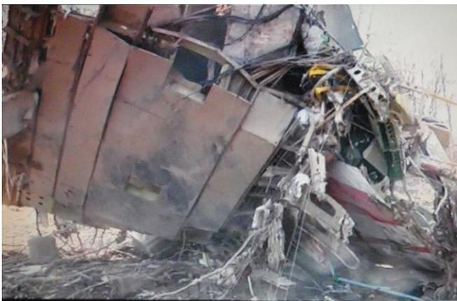
Fig. 24. Vue du plancher de l'avion Tu-154 pendant le soulèvement du fuselage [13]. Une éjection vers l'extérieur du plafond et des bords déchirés du fuselage ainsi que son détournement en l'air a conduit à la chute de telle manière que le plancher restait adjacent au sol avant le soulèvement. Il n'y avait pas de corps des passagers de même que de fauteuils sous le plancher. On ne voit que des rails pour fixation de fauteuils.
