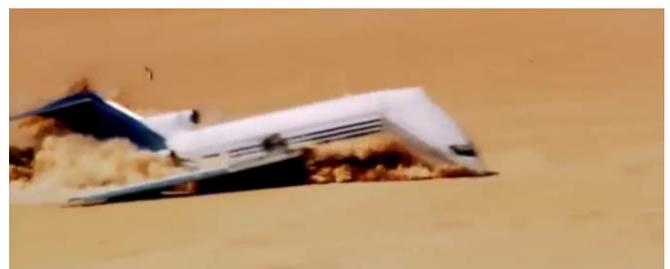
Fig. 10. Essai expérimental de la collision du Boeing 727-200 avec le sol dans le désert au Mexique le 27 avril 2012. Le film montre comment la destruction de l'avion se produit pendant sa chute [7].
