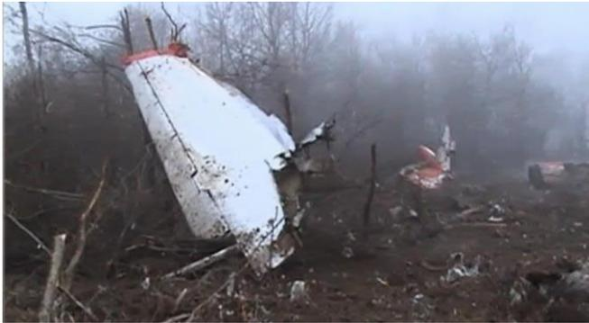
Fig. 22. Partie arrière droite du stabilisateur avec le gouverne de profondeur. Vue de la surface basse. Le bord d'attaque est du côté droit. La partie basse du stabilisateur a un fragment arraché vers la direction du vol [18].
