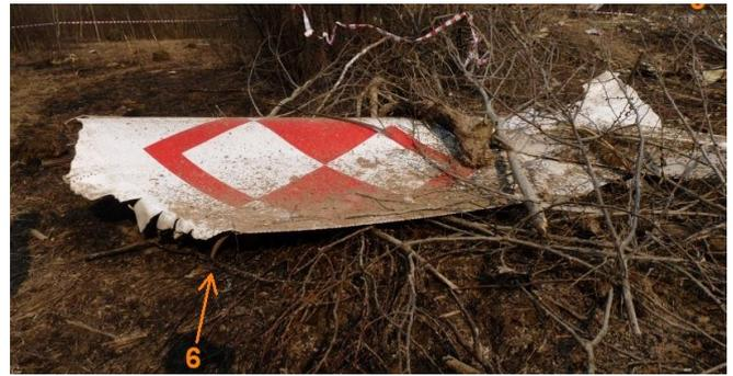
Fig. 25. Fragment du revêtement de la terminaison de l'aile gauche avec le fragment du carénage de la glissière du volet (6). On voit le stabilisateur horizontal droit au fond (3) [17]. Le revêtement supérieur a été broyé et ses morceaux restent sur des endroits éloignés.
