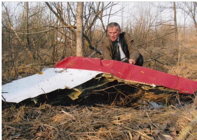
**Fig.18. Fragment du stabilisateur horizontal gauche placé dans la forêt à 5 m environ de la rue Kutuzow. Au fond derrière les arbres, on voit tout l'aileron. Photo prise par Jan Gruszyński. Les déformations de ce fragment excluent que son détachement ait pu se produire lors du choc contre l'obstacle de terrain.**
