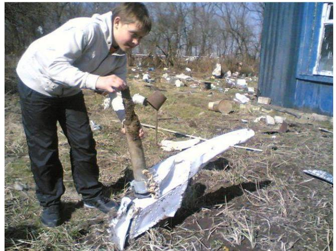
Fig. 13. Commande d'un volet extérieur de l'aile gauche avec un fragment de celui-ci retrouvé au pied du bouleau de Bodin [11].
