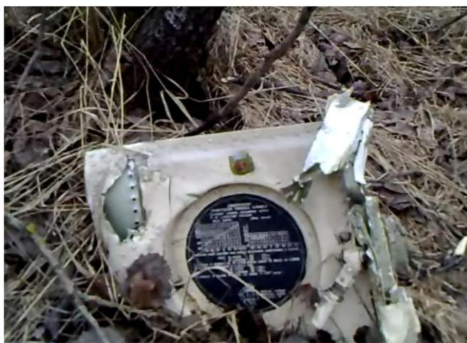
**Fig.19. Fragment de l'amortisseur du train d'atterrissage principal posé entre les arbres dans la zone B4 [16].**
