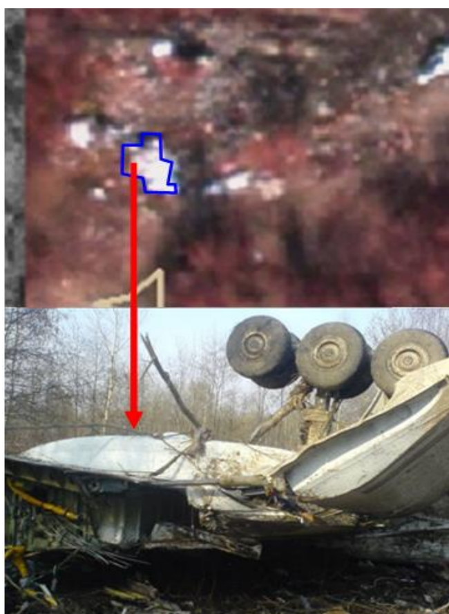
Rys. 4. Detekcja zmian – w wieloboku u góry obiekt zidentyfikowany jako prawe podwozie, poniżej jego zdjęcie z miejsca katastrofy. Źródło: zobrazowanie i zdjęcie Internet Google, grafika własna.
