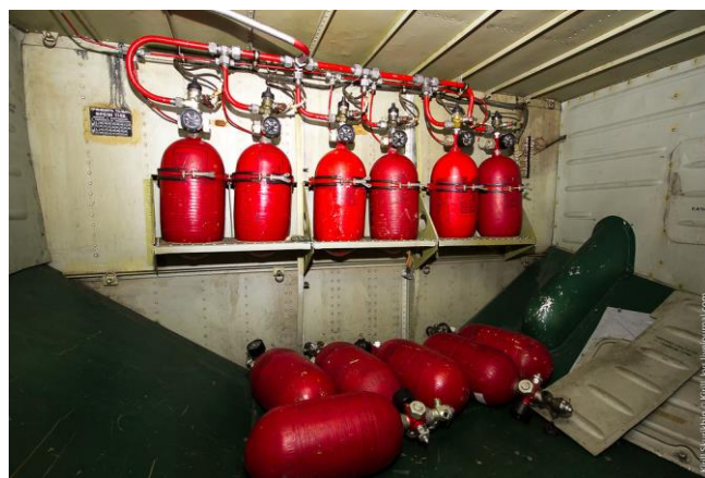
Rys. 6. Rozmieszczenie gaśnic w przedziale technicznym Tu 154 M [ 22].
