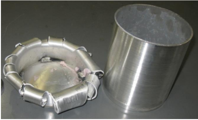
Rys. 7. Eksperymentalny rezultat zniszczenia sabotu dla prędkości 300 m/s.
