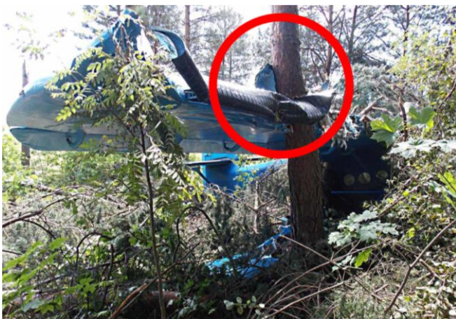
Rys. 12. Forma zgniecenia poszycia krawędzi przedniej i wywinięcie ponad powierzchnię samolotu An-2T [7](widok od przodu).
