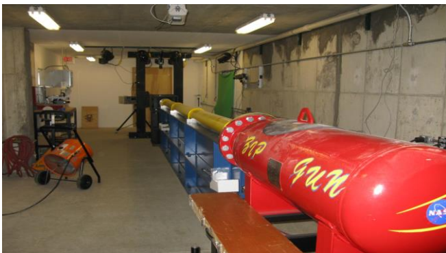
Rys. 5. Działko próżniowo-gazowe oraz w oddali płyta stalowa uderzana przez sabot.
