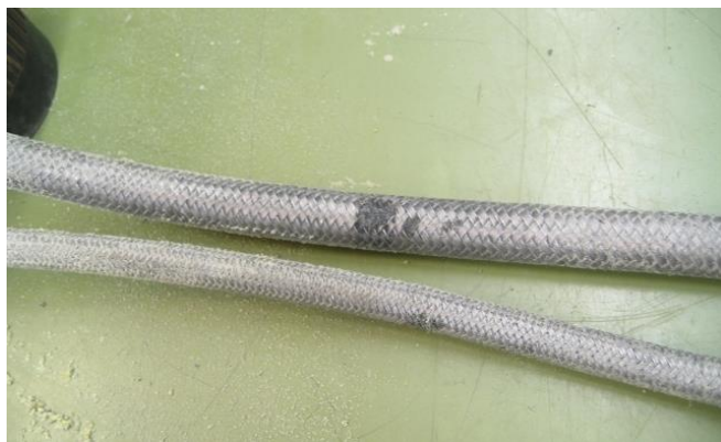
Rys. 7. Widoczne nadpalenie przewodu paliwowego [8].
