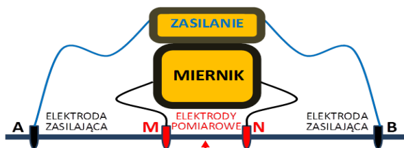
Rys. 1. Układ pomiarowy Schlumbergera [1].
