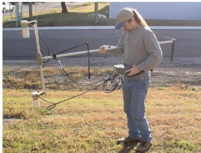
Rys. 10. Pomiar magnetometrem protonowym w układzie gradientowym [14].
