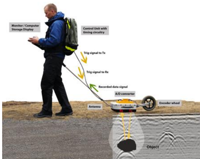
Rys. 6. Technika profilowania refleksyjnego [5].
