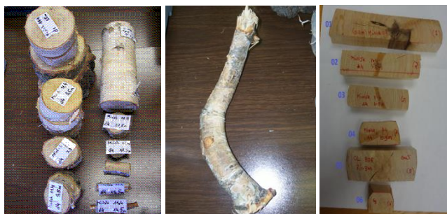
Rys. 2. Próbki z gałęzi brzozy 01 – 04 wycięte z jednego drzewa polskiego, 05 – z drugiego polskiego drzewa, 06 z gałęzi brzozy smoleńskiej.
