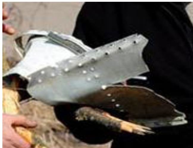
Rys. 5. Poszycie z wyrwanymi nitami. Części struktury samolotu. Nity poszycia pokazujące zniszczenia w wyniku ciśnienia wewnętrznego.
