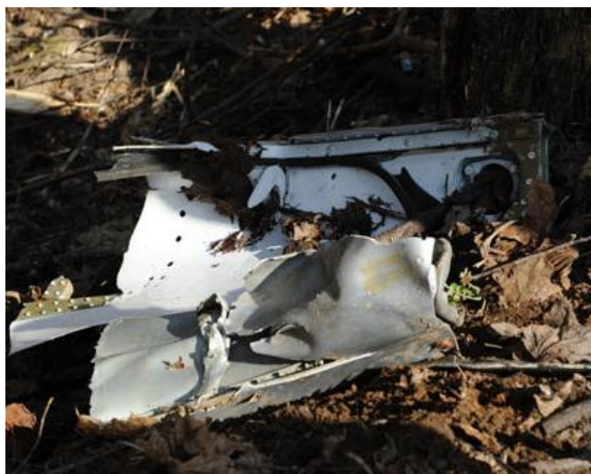
Rys. 4. Część poszycia samolotu pokazująca nitę zniszczone przez naprężenia rozciągające.
